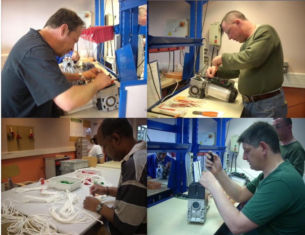
Cinq usagers encadrés par une monitrice, réalisent le câblage et le montage de divers composants pour l'industrie de la motorisation de portes et portails : Assemblage de carte pic, câblage de moteur, sachet tirette, kit chaîne, Kit poignées et kit d'assemblage.
